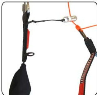
Vrchní pozice kladky od řídicí šňůry
